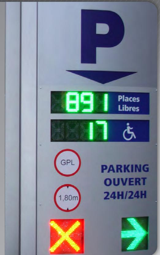
Nuestro sistema prevé la posibilidad de cualquier futura ampliación, agregando tanto sensores / indicadores, como carteles indicadores de plazas disponibles. Ello se logra entre otras razones, mediante el uso de conectores tipo Plug & Play, que otorgan la máxima confiabilidad y flexibilidad al sistema, al poderse agregar / reemplazar en cualquier momento, tanto elementos adicionales del sistema como Pantallas de publicidad (backlights, mensajes de texto variables en LEDs, etc.)
